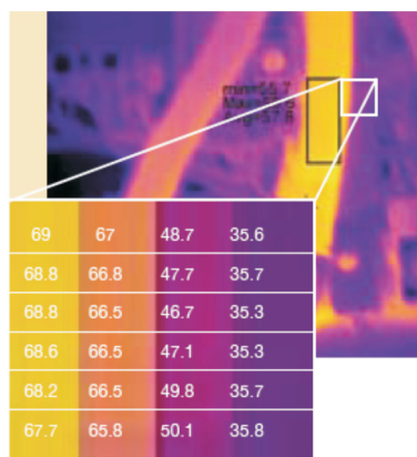
Figura 1 – Termovisores mostram as diferenças de temperatura de cada ponto da imagem
