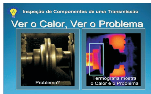
Figura 1 - A termografia mostra o calor e o problema
