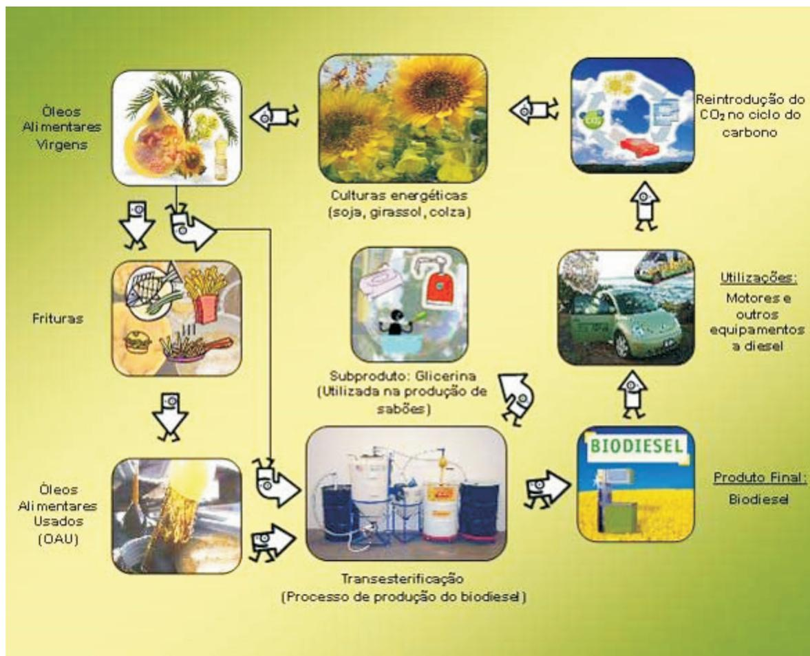
Figura 2 - Esquema representando a produção e a utilização do biodiesel
