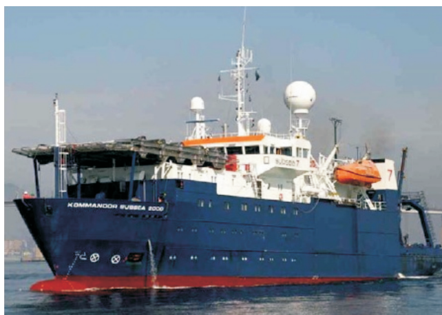
Figura 3 – Embarcação utilizada em inspeções submarinas com robôs (RSV)
