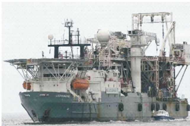
Figura 1 – Embarcação para lançamento de linhas
