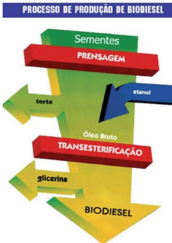
Figura 3 – Processo do biodiesel
