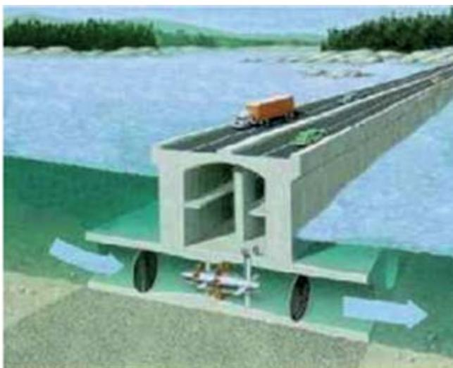
Figura 6 - Caixa de concreto por onde, no sobe e desce das marés, passa a água do mar cuja energia é aproveitada na geração de eletricidade.
