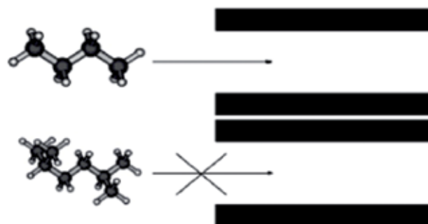
Figura 1 - Princípio básico de uma peneira molecular Fonte: Braga, 2007
