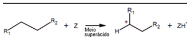
Figura 14. -Etapa de iniciação: mecanismo 3 Fonte: Scherer, 2009
