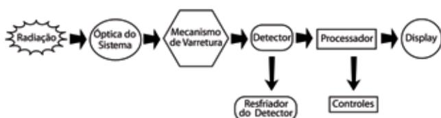
Figura 4 - Esquema representativo dos elementos básicos de um sistema infravermelho
