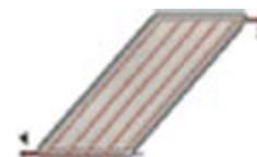
Figura 4 - Calor das placas transmitido para a água que circula no interior das tubulações de cobre
