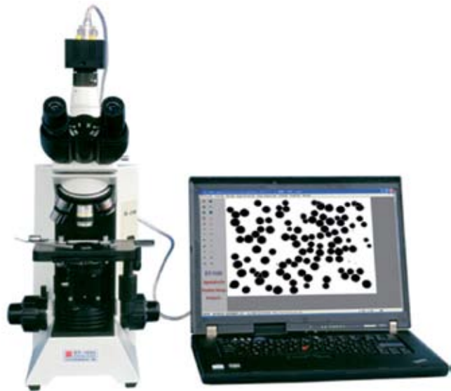
Figura 8 - Microscópio que pode ser realizado em análises de partículas
