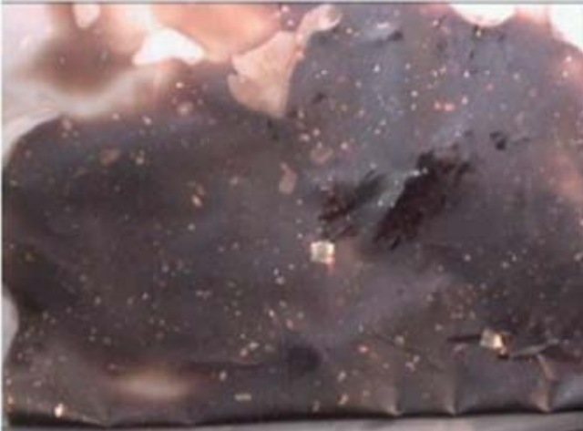
Figura 3 - Amostra de óleo saturado devido à grande quantidade de partículas
