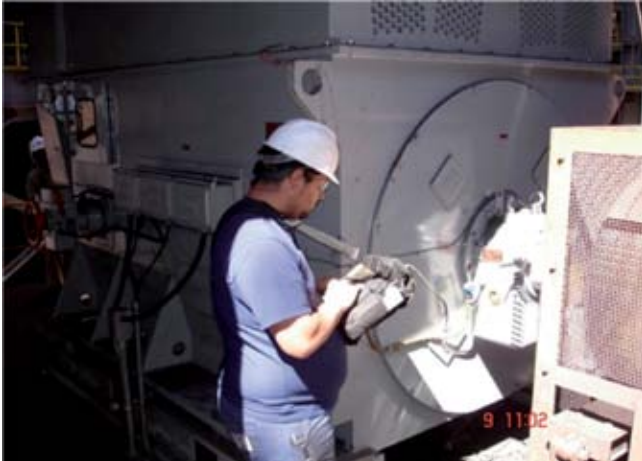
Figura 5 - Mecânico realizando análise de vibração
