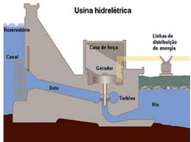
Figura 10 – Funcionamento de uma hidrelétrica
