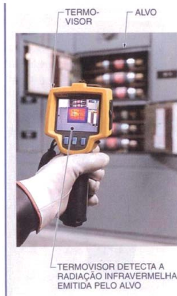
Figura 2 - Alvo é um objeto que deve ser inspecionado com o uso de um termovisor. A finalidade de um termovisor é detectar a radiação infravermelha emitida pelo alvo
