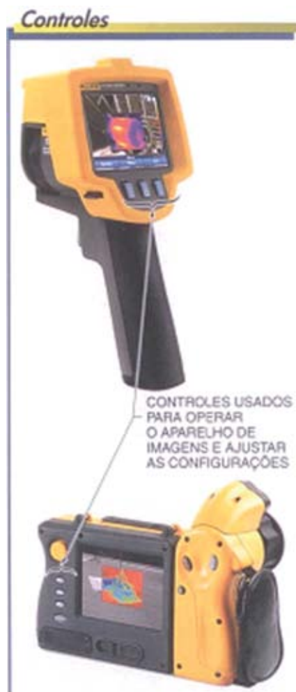
Figura 5 - Por meio dos controles, podem-se fazer ajustes em importantes variáveis tais como a faixa de temperatura, o intervalo e o nível térmico e outras configurações Fonte: Fluke Corporation, (The Snell Group; American Technical Publishers, Inc) - Introdução aos princípios da termografia., 2009
