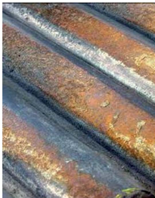
Figura 1 - Corrosão-erosão
