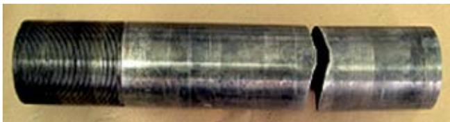
Figura 3 - Corrosão sob fadiga
