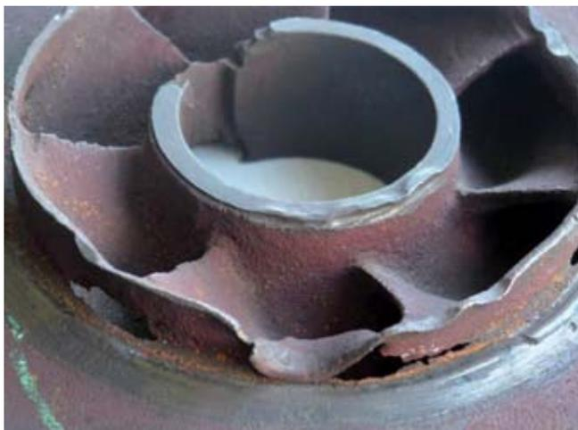
Figura 2 - Corrosão por cavitação
