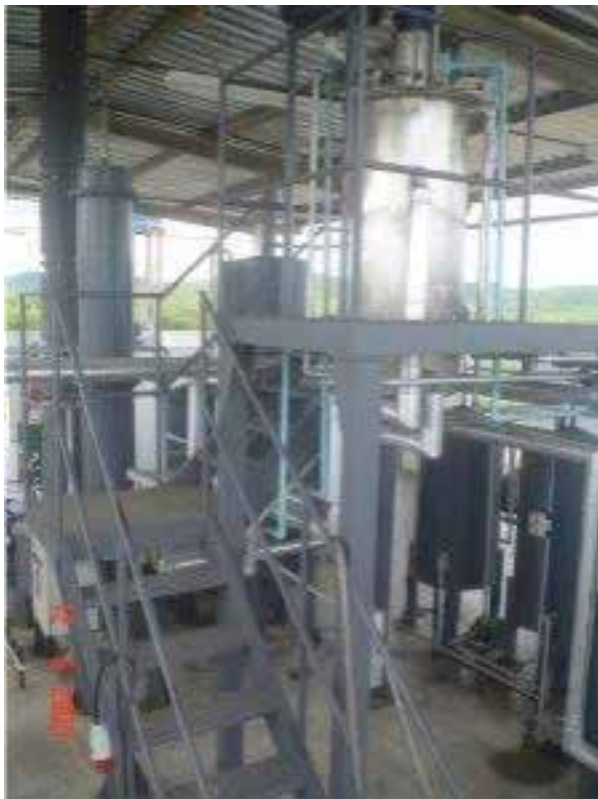
Figura 4 - Miniusina de biodiesel para produção em pequena escala
