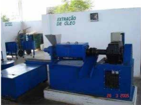
Figura 3 - Prensa para extração de óleo de mamona em miniusinas
