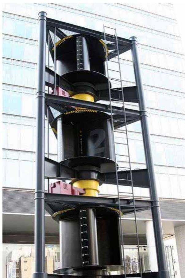
Figura 3 – Aerogerador de eixo vertical tipo Savonius
