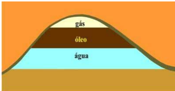
Figura 1 - Exemplo de um reservatório típico de petróleo Fonte: Apostila de Processamento Primário de Petróleo da Universidade Petrobras de Ciência e Tecnologia E&P Disponível em: www.moodle.ufu.br/
