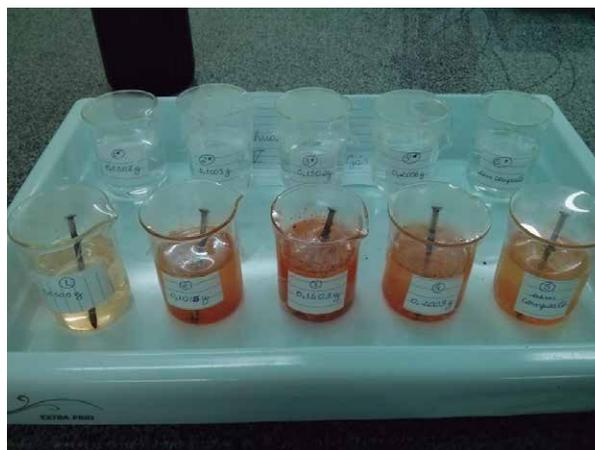
Figura 2 – Corrosão das peças de aço-carbono
