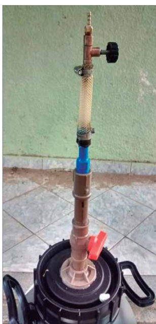
Foto 1 - Ilustração do sistema de válvulas instalado na tampa
