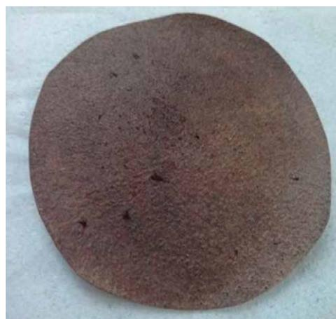
Figura 2 - Foto do papel de filtro da precipitação de asfalto da solução do petróleo “2”; tendo como solvente comercial o querosene
