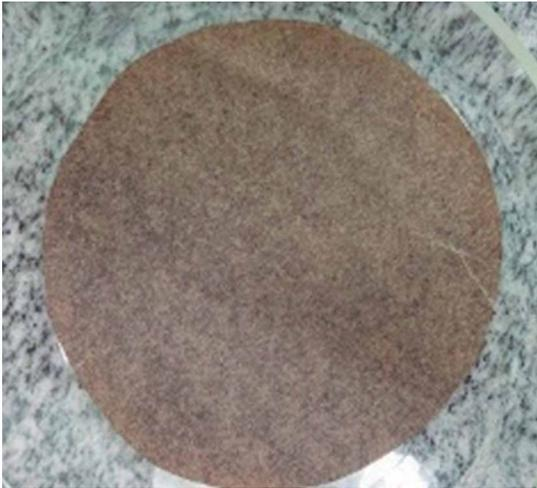
Figura 4 - Foto do papel de filtro da precipitação de asfalto da solução do petróleo "2"; tendo como solvente comercial a gasolina
