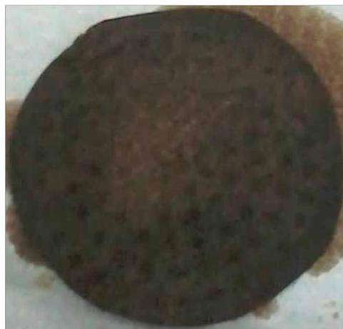
Figura 1 - Foto do papel de filtro da precipitação de asfalto da solução do petróleo “1”; tendo como solvente comercial o querosene
