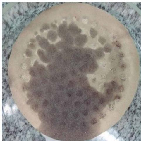
Figura 3 - Foto do papel de filtro da precipitação de asfalto da solução do petróleo “1”; tendo como solvente comercial a gasolina
