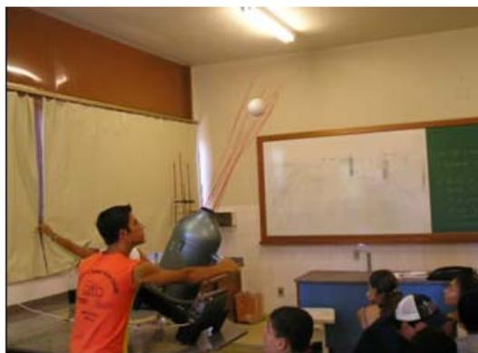
**Figuras 2 e 3: Experimento que mostra o movimento da corrente de ar e sua influência sobre uma esfera de isopor**
