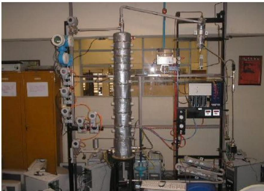
**Figura 2:** Coluna de destilação piloto do laboratório de pesquisa e desenvolvimento em automação do CEFET Campos
