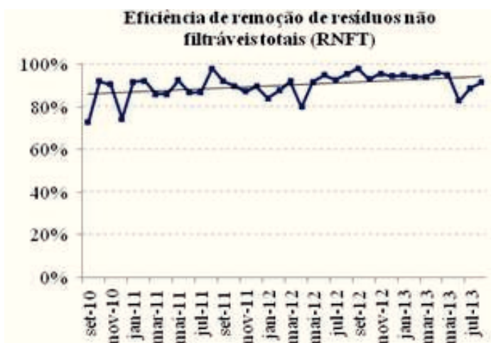
Figura 10. Eficiência de remoção dos resíduos não filtráveis totais (RNFT) de setembro de 2010 a agosto de 2013
