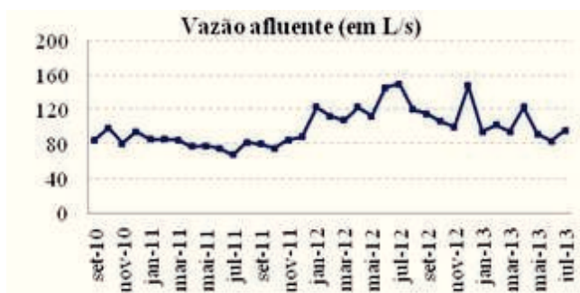
Figura 2. Valores mensais médios de vazão afluente entre setembro de 2010 e agosto de 2013
