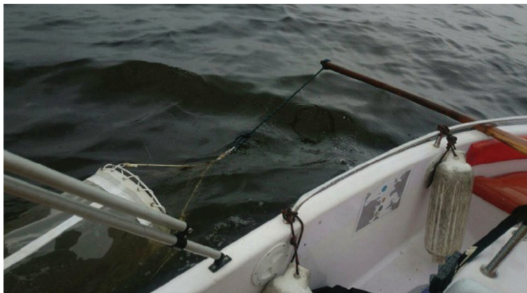
Figura 6. Rede de náilon utilizada para coleta de amostras
