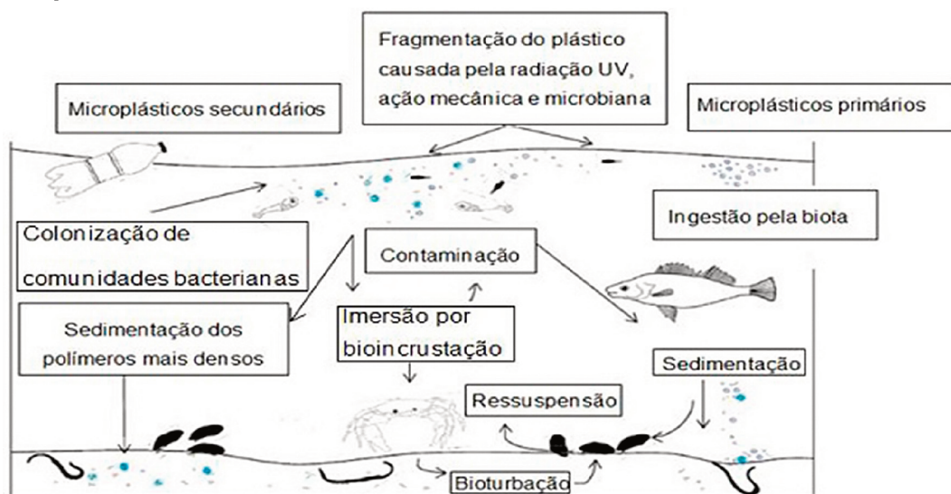
Figura 8. Possíveis vias de transporte de microplásticos para o ambiente aquático e suas interações biológicas
