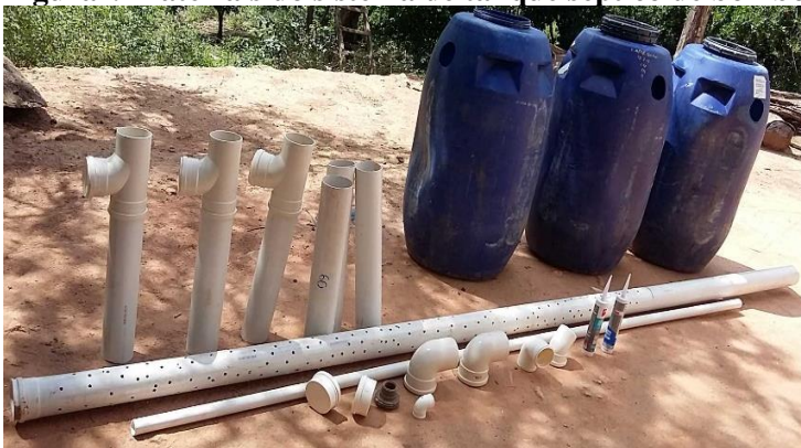
Figura1. Materiais do sistema de tanque séptico de bombonas
