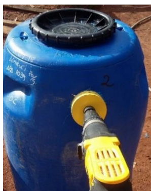
Figura 9. Perfuração das bombonas com uso de serra copo de 102 mm
