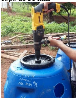
Figura 10. Perfuração da tampa da primeira bombona com uso de serra copo de 51 mm
