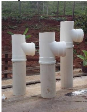
Figura 11. Dispositivo de saída: Tê de 100 mm e tubo de 30 cm de comprimento
