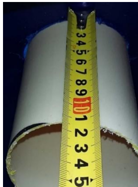
Figura 12. Tubo de 100 mm para conexão do dispositivo de saída
