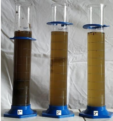
Figura 27. Efluentes das câmaras do tanque séptico em série
