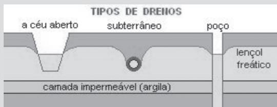
Os chamados **drenos a céu aberto** ou *canais de drenagem* são valas escavadas no solo, geralmente de seção trapezoidal, destinadas a escoar a água empoçada na superfície. Nas áreas agrícolas, deve-se cuidar de não aprofundá-la demais, para não privar o solo da umidade necessária ao desenvolvimento das plantas.
