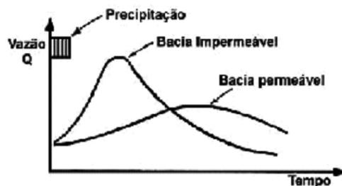
Figura 8: Características da vazão de um rio de acordo com a permeabilidade do solo
