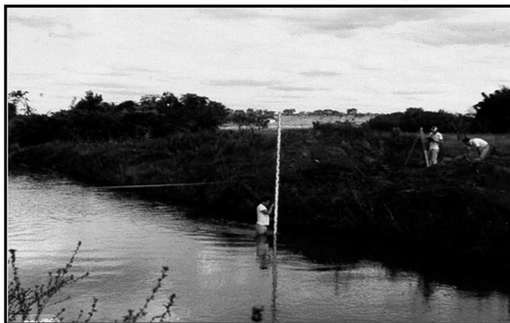
Figura 3: Régua graduada - medida de profundidade com régua no Rio Salitre – Bacia do rio Paranaíba
