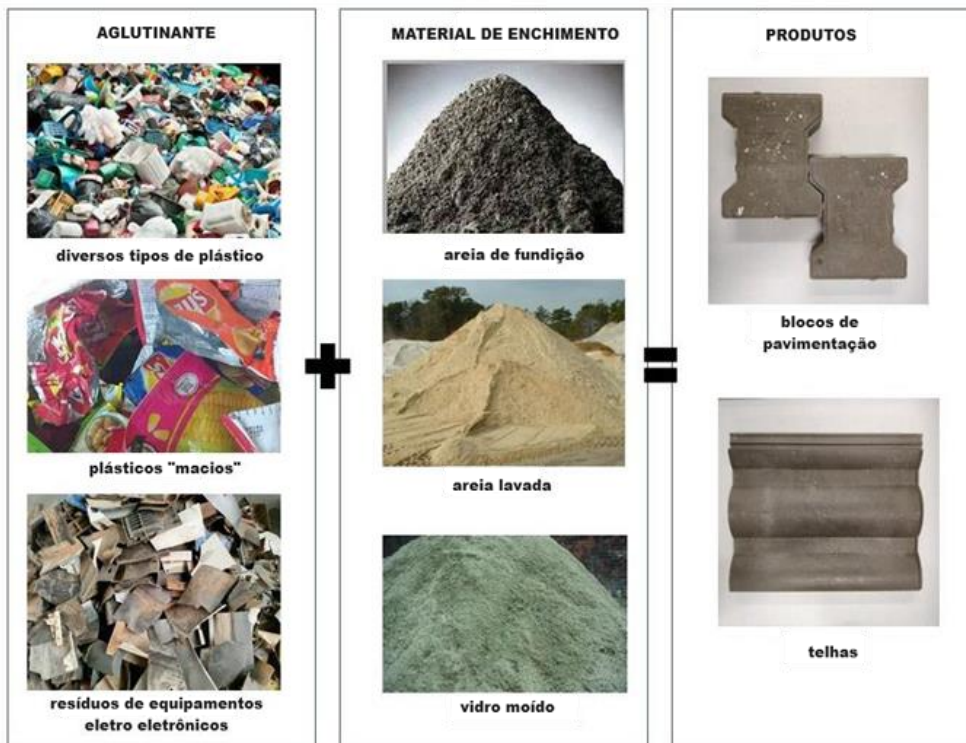
Figura 1. Matérias primas e produtos do compósito plástico-areia
