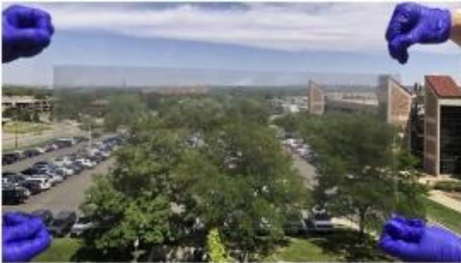
Figura 1. Película termocrômica de dióxido de vanádio
