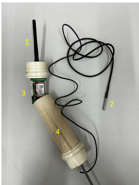
Figura 3. Imagem do dispositivo piloto desenvolvido com: 1 - Antena, 2 - Sensor de temperatura DS18B20, 3 - Sistema eletrônico e 4 - Invólucro de proteção em PVC.
