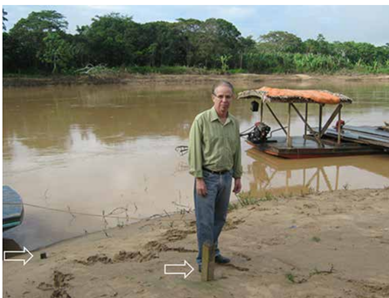
Figura 10: Régulas limnimétricas de 1 m de comprimento sob os sedimentos do rio Acre em Porto Acre
