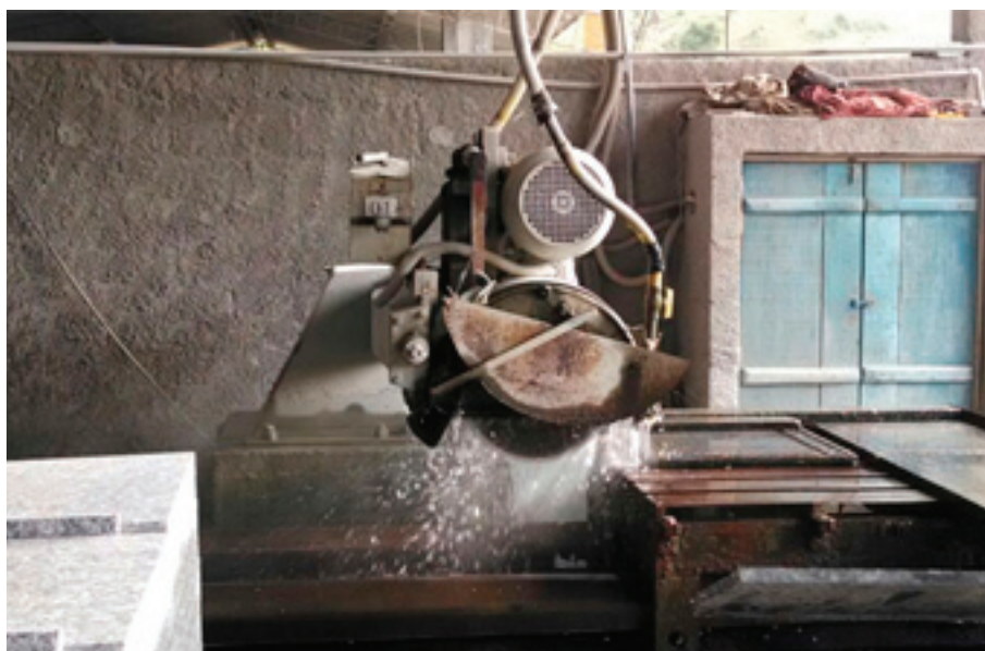
Figura 8 – Desperdício de água e energia
