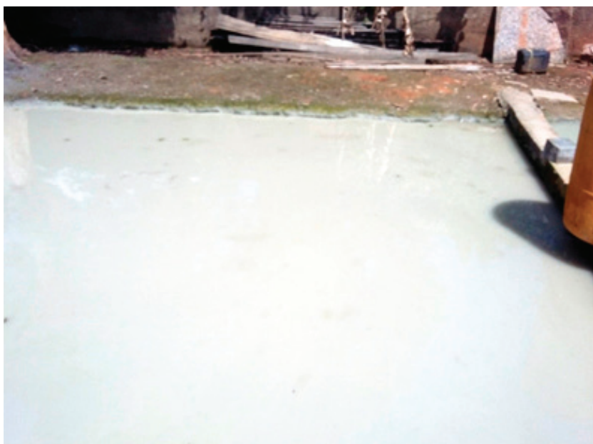
Figura 10 – Lama abrasiva, resultado do corte das rochas
