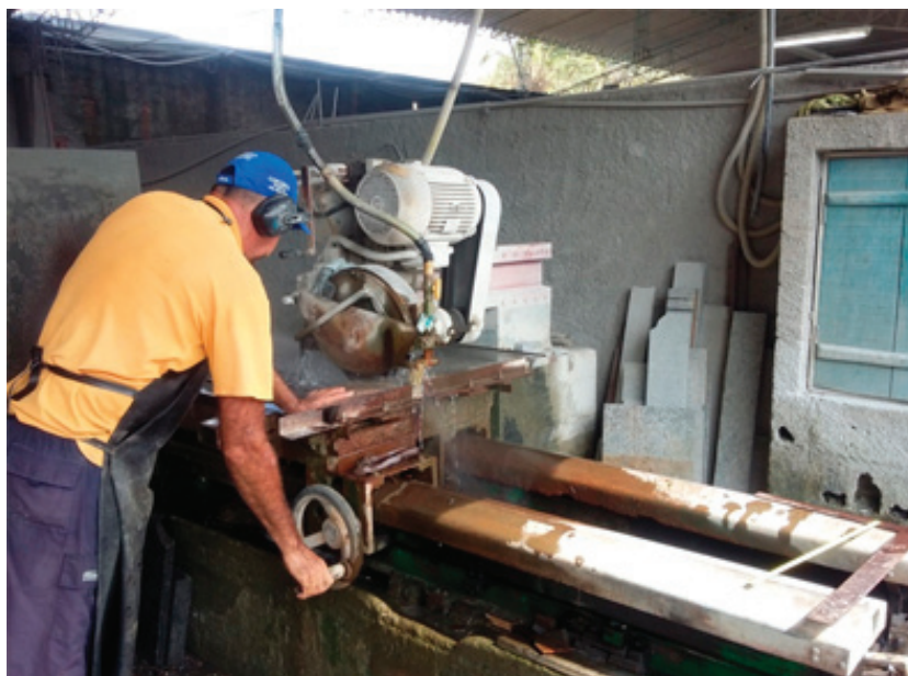
Figura 9 – Processo de corte de chapas na serra circular
