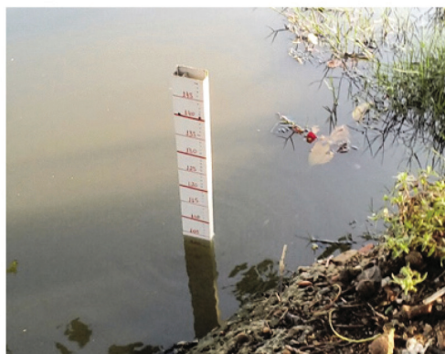
Figura 3: Foto de régua limnimétrica instalada, enviada por morador em 17/09/2016 via WhatsApp
