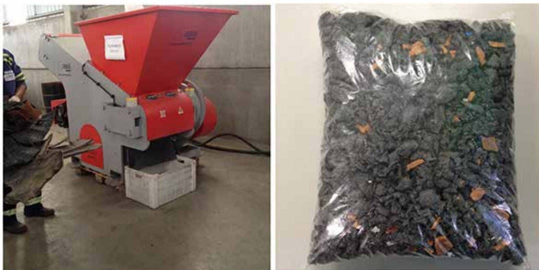
Figura 14: Material com granulometria 0,5 mm
