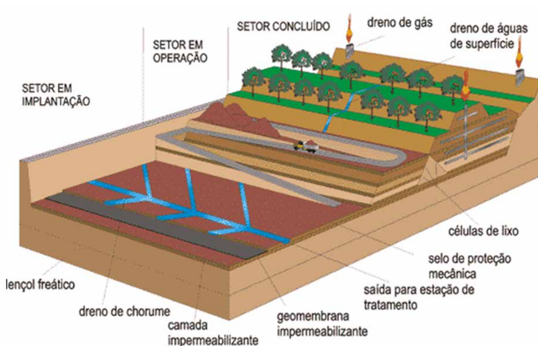
Figura 6: Forma construtiva de um aterro classe 2
