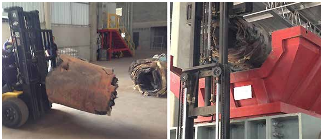
Figura 12: Anéis na primeira linha de trituração
