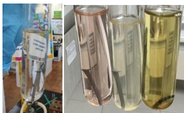
Figura 1 e 2. Pregos em meio corrosivo com extratos de goiaba, manga, maracujá e sem extrato, respectivamente.
