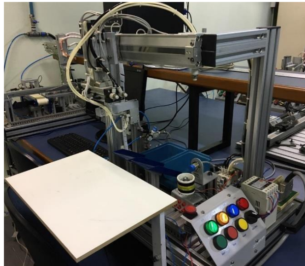
Figura 1. Estação 3 do Sistema Flexível de Manufatura da SMC.
