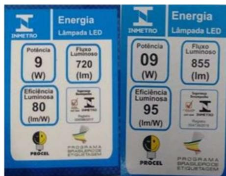
Figura 1. Selos de identificação de conformidade de lâmpadas LED<sup>[3]</sup>
