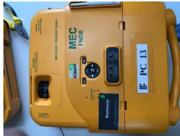
Figura 2. Computador Interativo Reparado, Modelo PC-3500Wi da fabricante Daruma. Fonte: Autoria própria.
