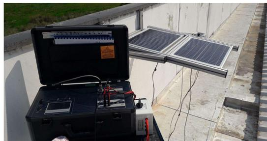
**Figura 1.** Traçador de Curva I-V portátil para medição da curva I-V no MFV.
