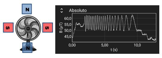
**Figura 1:**Módulo do campo magnético no instante em que o fornecimento de energia elétrica é interrompido para o motor direto na tomada até que o rotor cessa o movimento.
