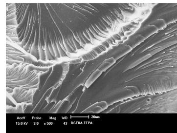
**Figura 5- MEV da fratura DGEBA/TEPA (500x).**
