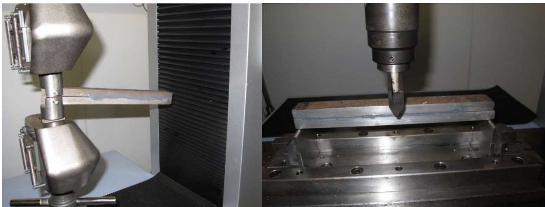
Figura 3 - Ensaio DCB e ENF. Espessura adesiva de 0,4 mm.
