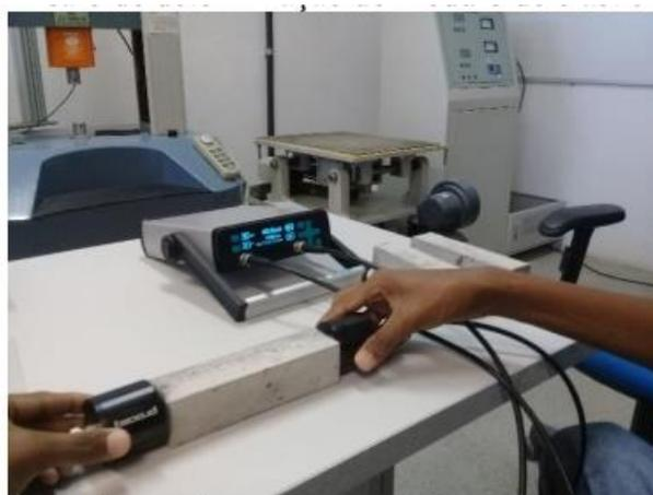
Figura 3 – Ensaio de Ultrassom em corpo-de-prova prismático.
