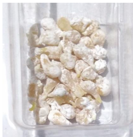
Figura 3: Fertilizante produzido a partir de quitosana e ácido fosfórico, o tamanho médio dos grânulos é de 4,0 mm +/- 0,5 mm.
