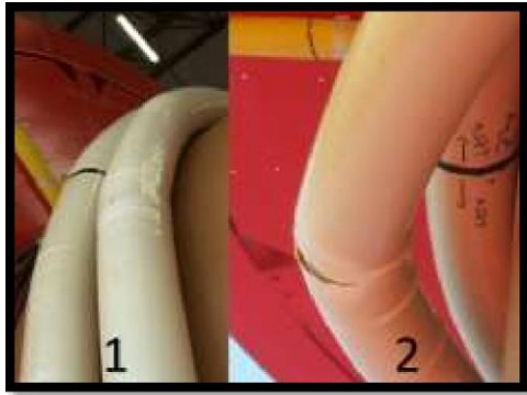
Figura 7 – Falha gerada por branqueamento devido à estricção local excessiva
