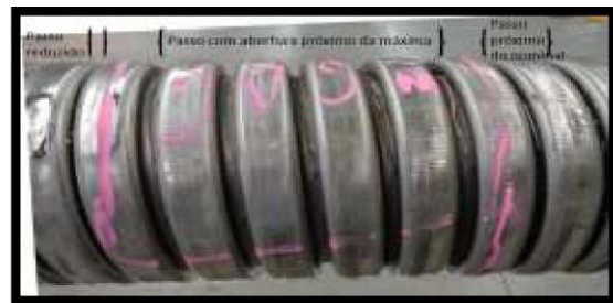
Figura 6 – Variação de passo em uma carcaça de duto flexível
