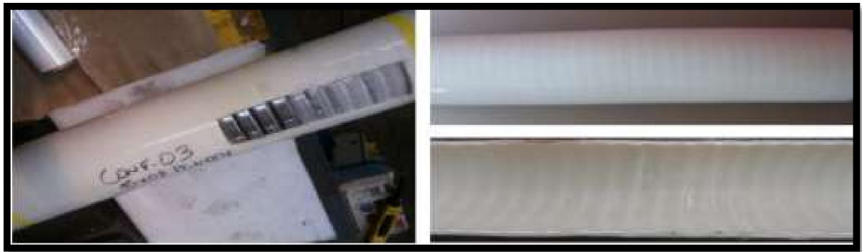
Figura 10 – Retirada de amostras da camada com ocorrência de branqueamento
