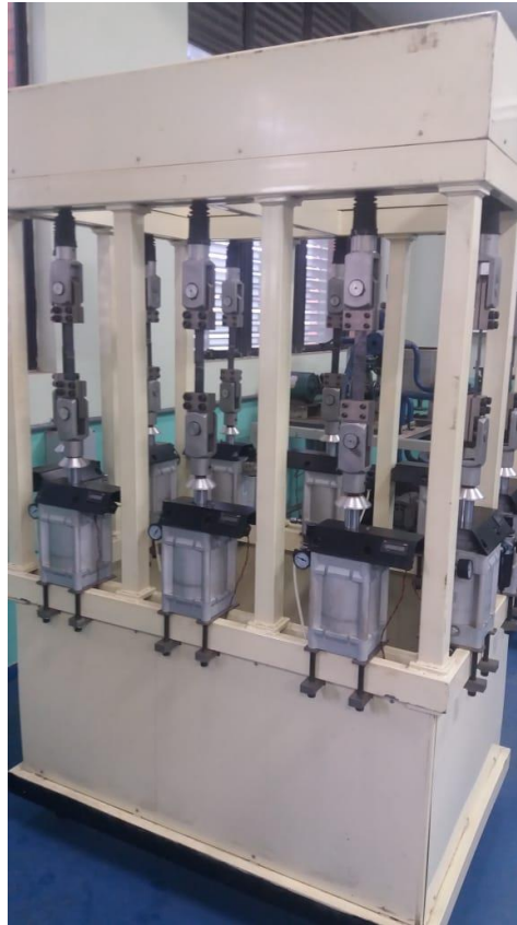
Figura 5 – Equipamento Pneumático de Fluência (EPF)
