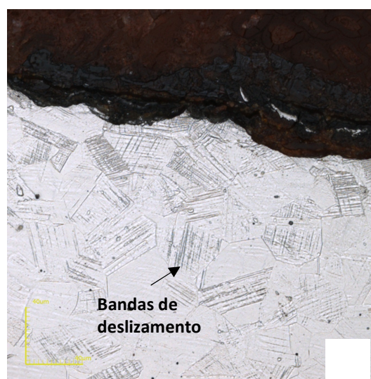
Figura 5: Microscopia Confocal da Amostra de Aço Inoxidável 304 no aumento de 1075x.
