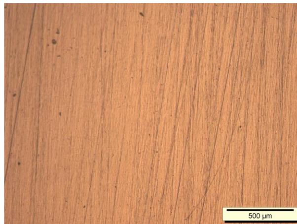
Figura 4 – Amostra de cobre após lixamento em lixa d’água na seqüência 200, 320, 420, 600, 800, 1000 e 1200. Micrografia após a lixa 1200. Ampliação 50x.
