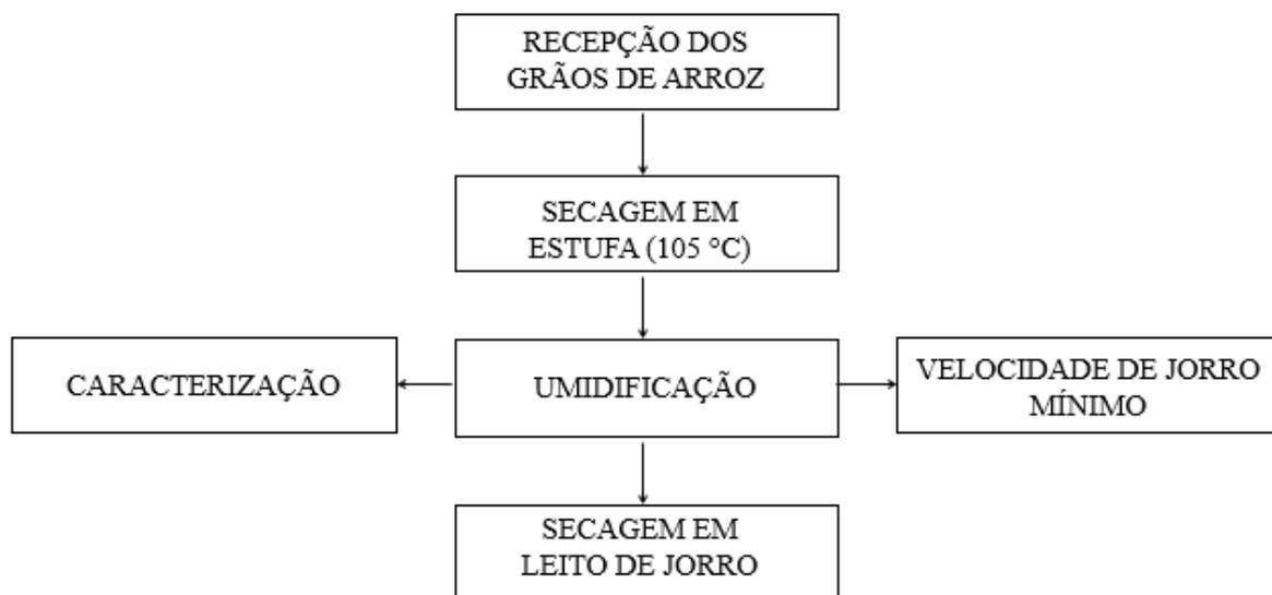
Figura 2 – Fluxograma do processo experimental de secagem do arroz com casca.
