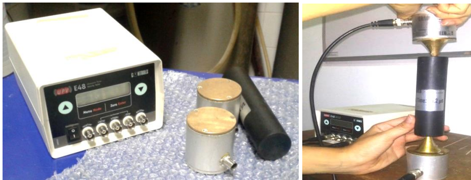
Figura 3 - Equipamento de Ultrassom com diferentes transdutores a) plano b) exponencial.
